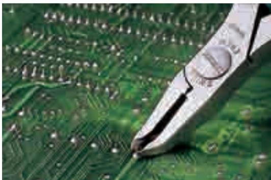
只有在 2412EW、2422EW、2432EW、2477EW、2482EW 的型号上才具有夹持剪下引脚的安全装置。
