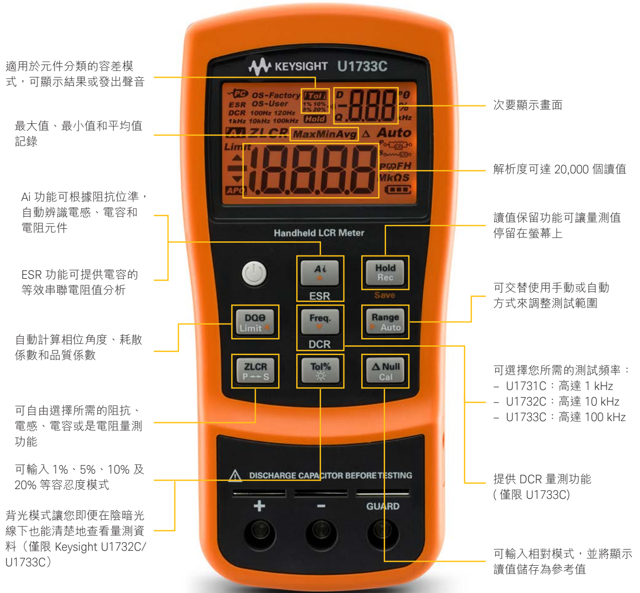
圖 2 : Keysight U1733C 前面板
