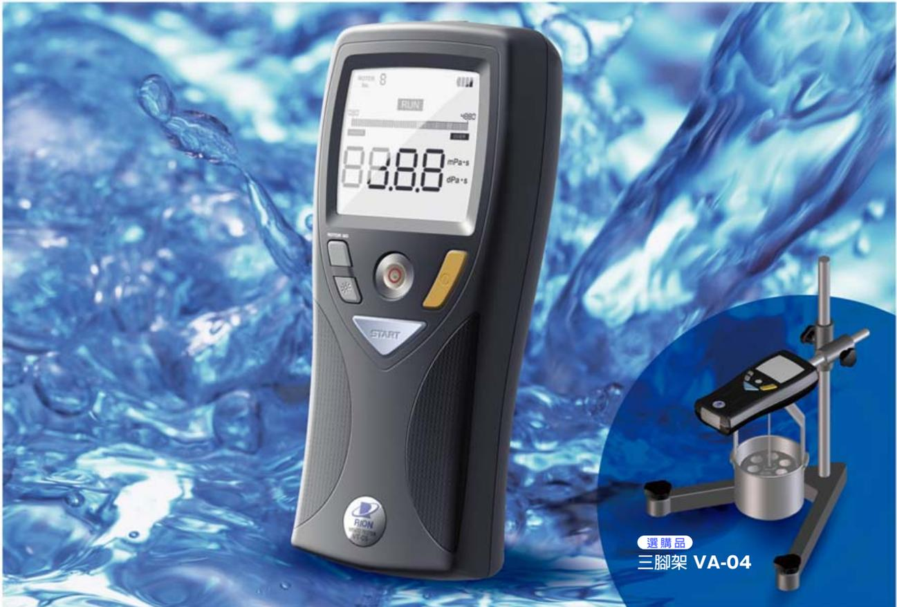
VT-05/06是用於大範圍黏度之量測，適合檢測如重油、油漆及黏著劑之類的工業用物質。其在食品與其他生產製造過程中，可用來做品質管制。於檢驗工程車輛及其他機械時，亦可用來量測液壓油、輕軸油與齒輪油等等。
