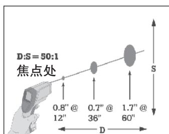
使用 Fluke 568 可以瞄准 8 m (25 ft.) 范围内的指定目标。如果距离再加长的话，测量区域将会变大（大约为距离除以 50）。
