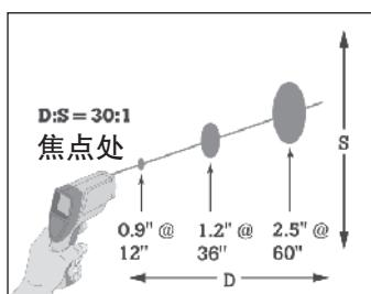
使用 Fluke 566 可以瞄准 5 m (15 ft.) 范围内的指定目标。如果距离再加长的话，测量区域将会变大（大约为距离除以 30）。
